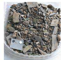
< Sable de rivière à Riols. Un seau de sable de rivière par gachée suffit à donner un aspect grenu au mortier.
