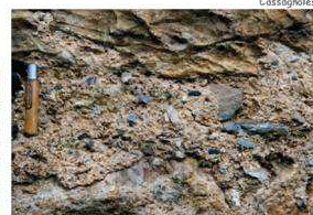
Joint pleins couleur terre. Mortier de chaux, sable grenu et terre.
